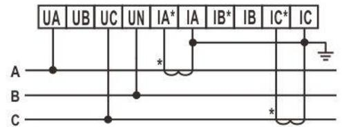
电压直接接入、电流经互感器接入
