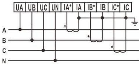
电压直接接入、电流经互感器接入
