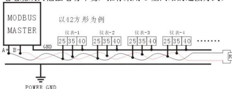
**MODBUS/RTU 通讯协议：**MODBUS 协议在一根通讯线上采用主从应答方式的通讯连接方式。首先，主计算机的信号寻址到一台唯一地址的终端设备（从机），然后，终端设备发出的应答信号以相反的方向传输给主机，即在一根单独的通讯线上信号沿着相反的两个方向传输所有的通讯数据流（半双工的工作模式）。
