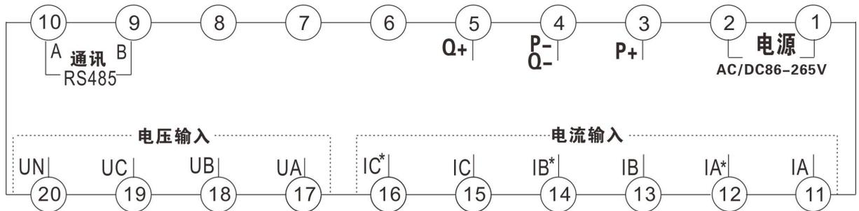
此接线图适用于所有外型无输出功能多功能电力仪表
