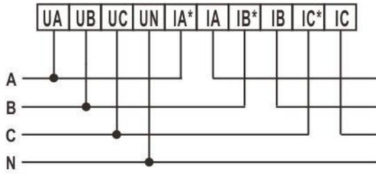
电压直接接入、电流直接接入
