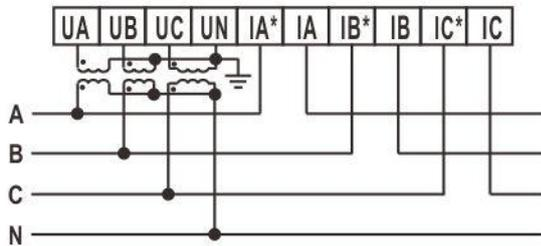
电压经互感器接入、电流直接接入
