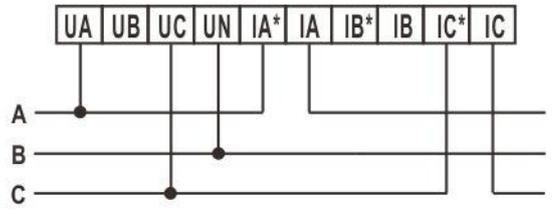
电压直接接入、电流直接接入
