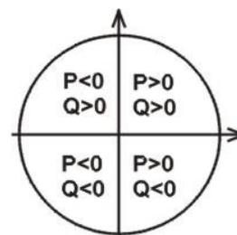
其中 P>0，累计的有功电能量是有功电能吸收，P<0，累计的有功电能是有功电能释放 Q>0，累计的无功电能是无功电能感性，Q<0，累计的无功电能是无功电能容性。
