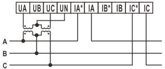
电压经互感器接入、电流直接接入
